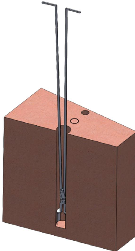
**Wir fertigen für Sie Ihre Kernfangzange mit abgewinkeltem Handgriff in der Größe und Länge die Sie für eine leichte Entnahme von Bohrkernen benötigen. Zum Beispiel auch als Tiefenlochkernfangzange (3 Meter) mit Hebevorrichtung.**
