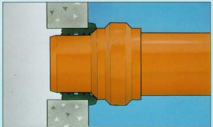
Der im Rohrstutzen eingebaute Montagestop verhindert ein Durchschieben des anzuschließenden Rohres.
