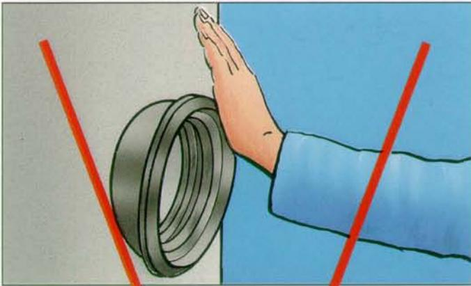
In die vorhandene Öffnung wird die Dichtung F-910 eingesetzt. Wichtig: Kein Gleitmittel verwenden.
