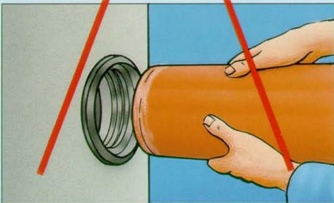
Rohr vorzentrieren und in die Dichtung einschieben. Bitte separate Montageanleitung beachten.
