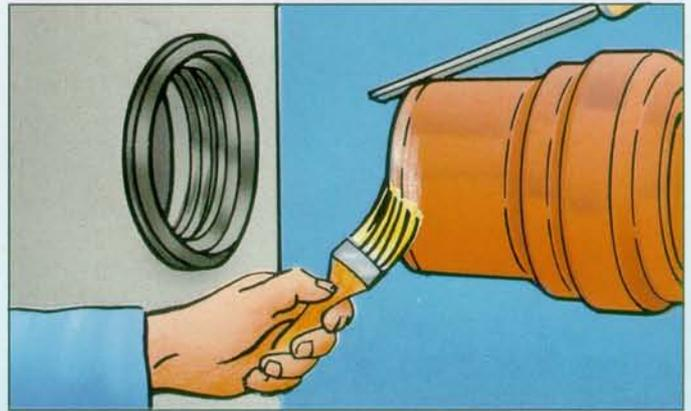
Rohrstutzen anfasen und original Forsheda-Gleitmittel auftragen. Wichtig: Besonders die Fase oder den Radius des Spitzendes gut einschmieren.
